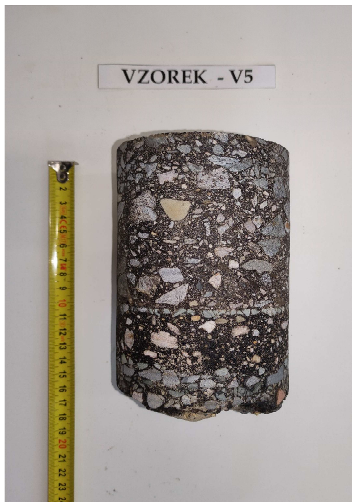
Obr. 10 - Jádro vývrtu Vzorek – V5 (laboratoř).
