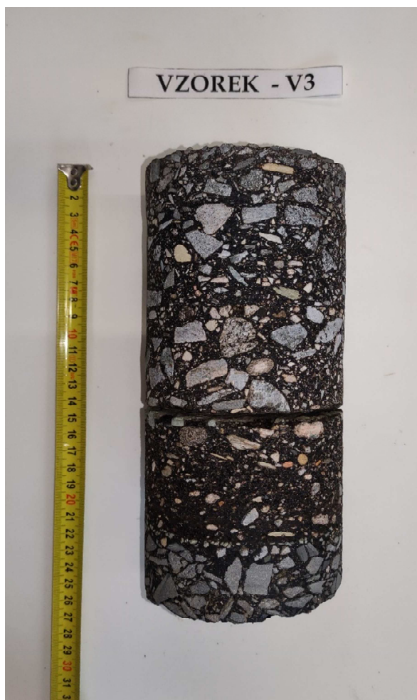
Obr. 6 - Jádru vývrtu Vzorek – V3 (laboratoř).
