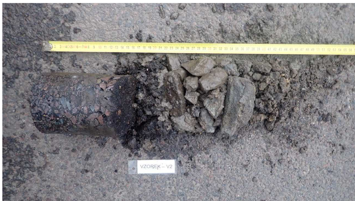
Obr. 3 - Jádro vývrtu Vzorek – V2 (in situ).
