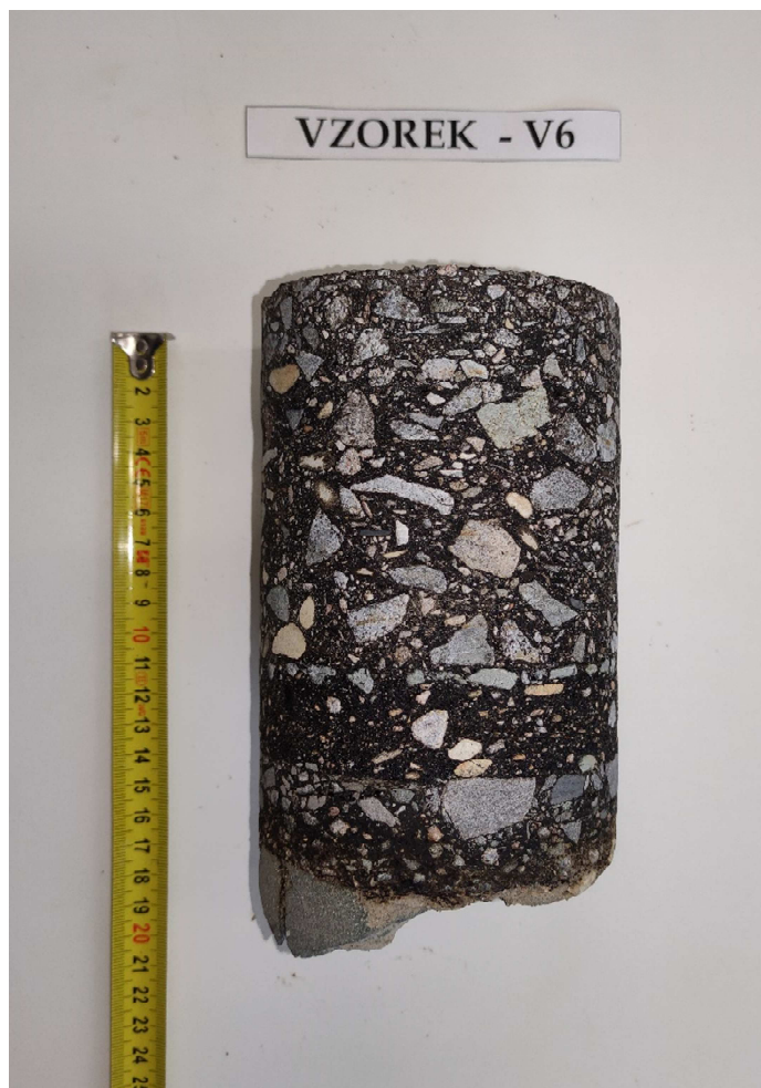
Obr. 12 - Jádru vývrtu Vzorek – V6 (laboratoř).
