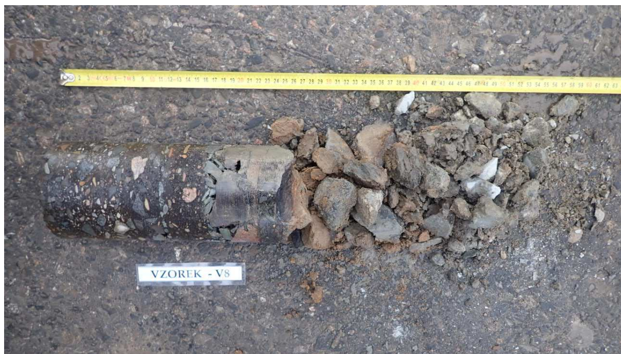
Obr. 15 - Jádru výtvetu Vzorek – V8 (in situ).
