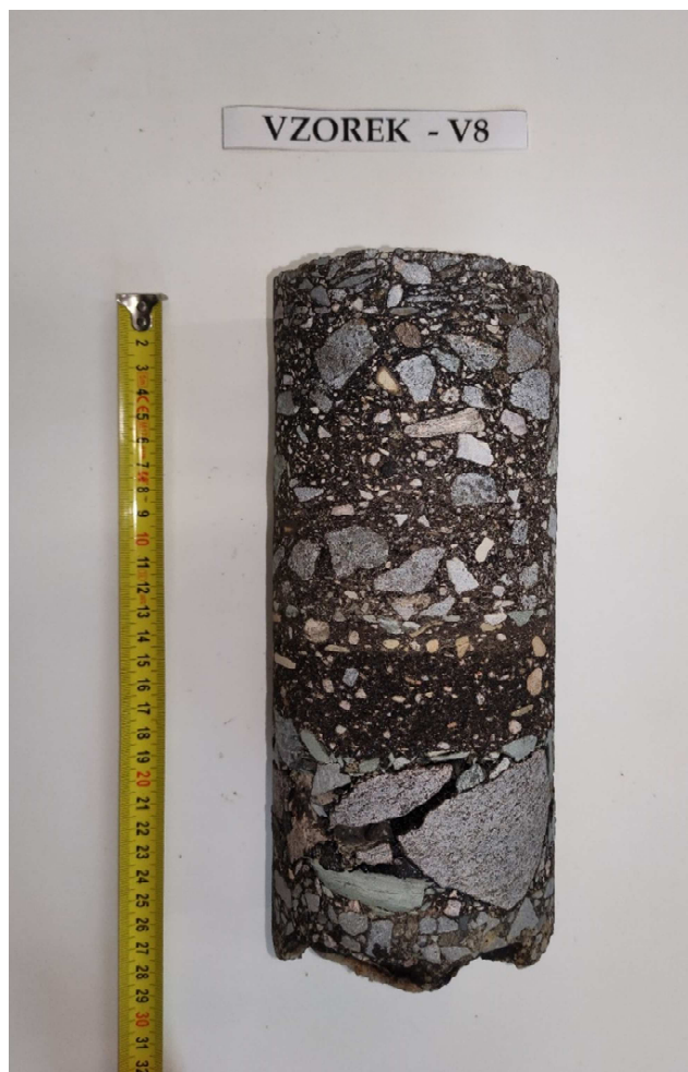
Obr. 16 - Jádro vývrtu Vzorek – V8 (laboratoř).
