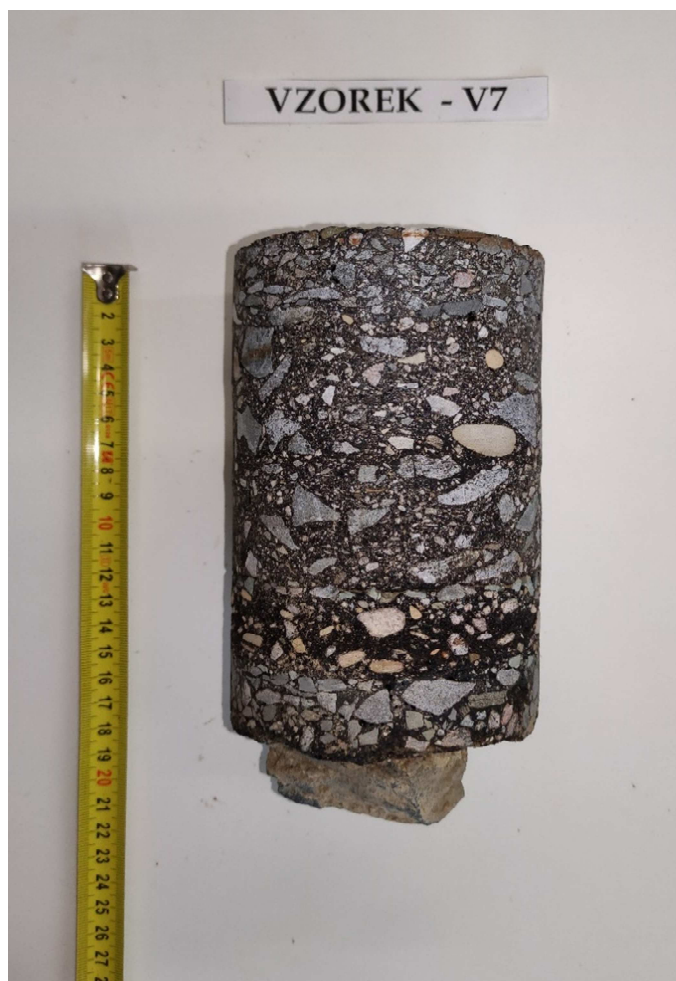
Obr. 14 - Jádro vývrtu Vzorek – V7 (laboratoř).
