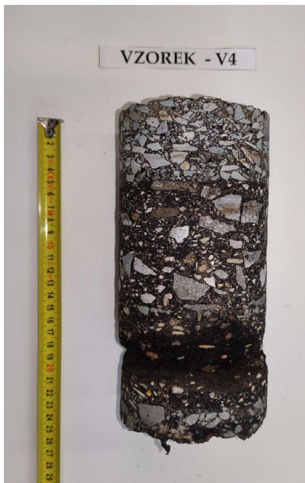
Obr. 8 - Jádru vývrtu Vzorek – V4 (laboratoř).
