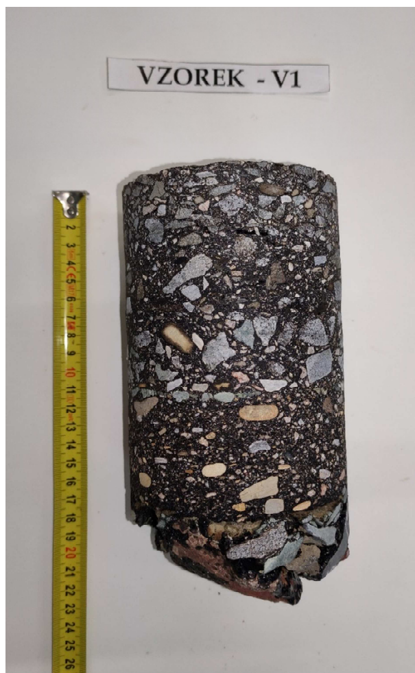
Obr. 2 - Jádru vývrtu Vzorek – V1 (laboratoř).
