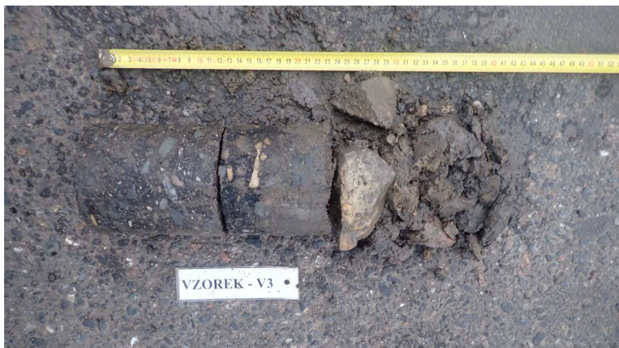
Obr. 5 - Jádro vývrtu Vzorek – V3 (in situ).
