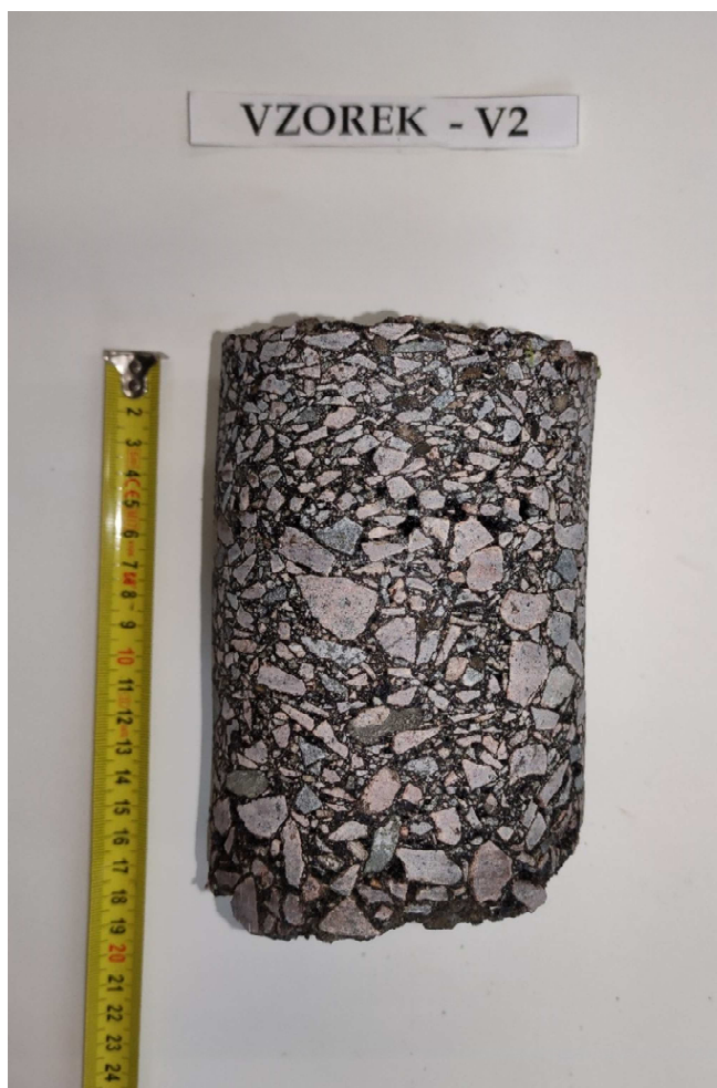
Obr. 4 - Jádro vývrtu Vzorek – V2 (laboratoř).
